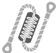
L'absorbeur d'énergie est obligatoirement utilisé dans des situations où l'utilisateur est exposé à un risque de chute. Le longe antichute sert à dissiper l'énergie en cas de chute et à limiter la force de freinage à un niveau non lésionnel.
