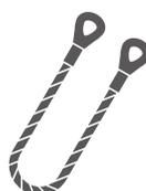
Les longes sont des éléments de liaison, elles peuvent intégrer un absorbeur d'énergie. Cet élément permet d'amortir le choc en cas de chute. Dans ce cas, cet équipement est couvert par la norme EN 355.
