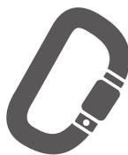
Les connecteurs sont des composants ouvrables essentiels dans l'assemblage des systèmes. La fermeture des connecteurs se divise en un minimum de deux actions (manuelles ou automatiques).
